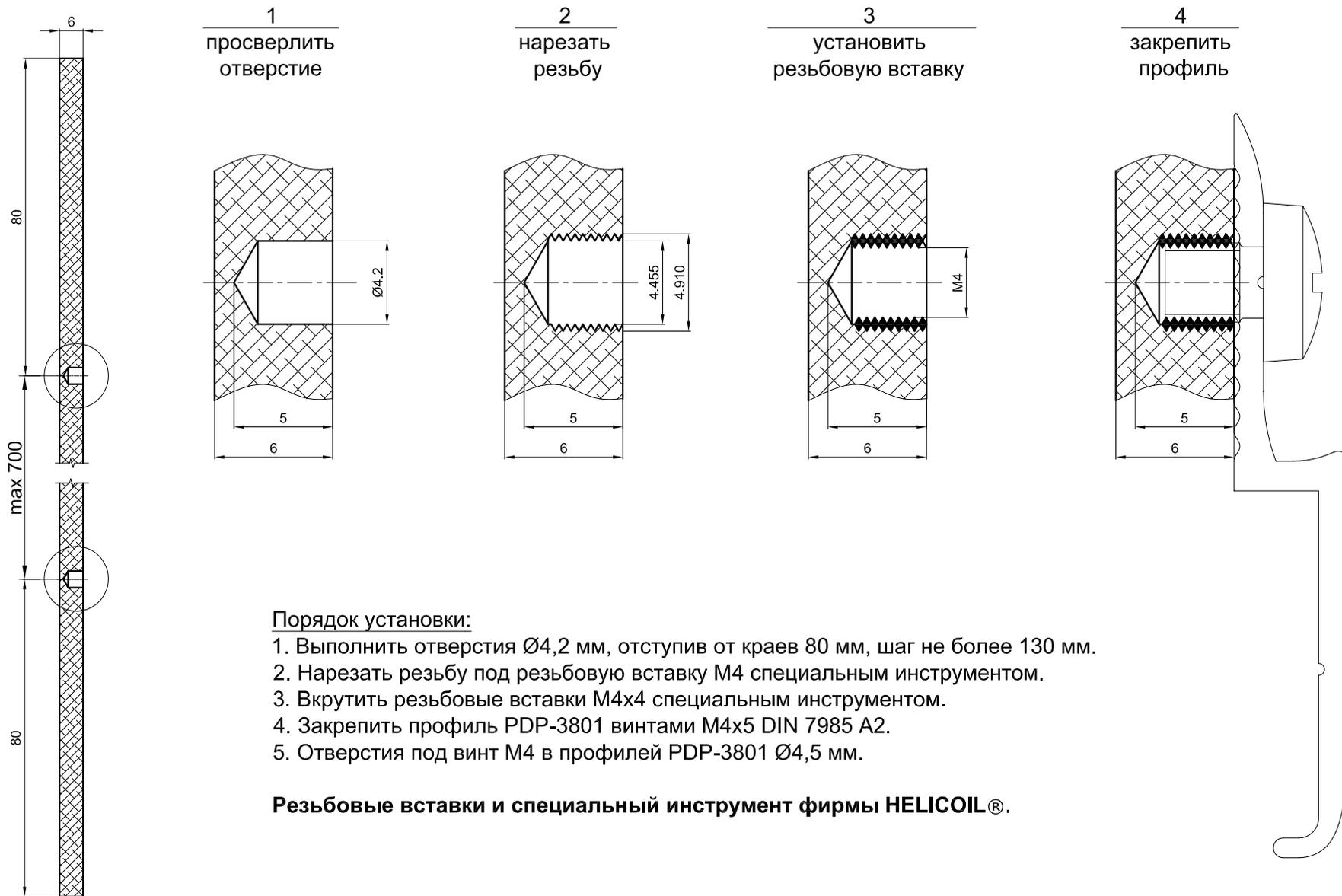
Крепление с помощью профиля PDP-3801, винтов и резьбовых вставок для панелей толщиной 8 мм
