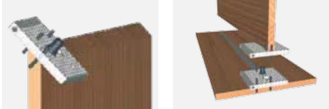
Присадка угловых соединений Присадка центральных перегородок
