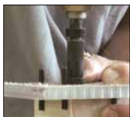
1. Присадите отверстия в ножке стола при помощи шаблона Rasto
